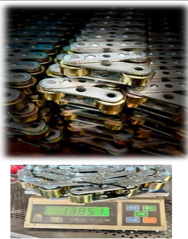
照片 6. 新式鍊條經財團法人金屬工業研究·發展中心驗證(MIRDC) 符合規定
