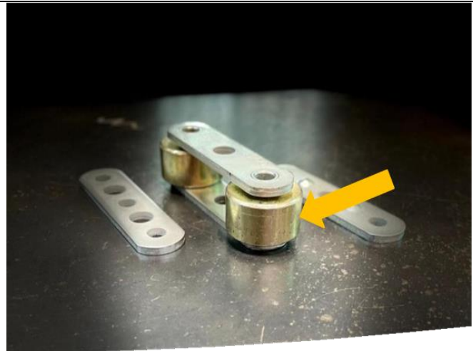
照片 2. 連結鍊片鏤空及鍍鋅，滾柱耐蝕處理
